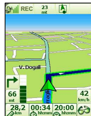
Fig. 3 - Cliccando sulla Barra "Strada corrente" si potranno visualizzare: il tempo, la distanza mancante alla tappa più prossima e l'ora prevista per l'arrivo.
